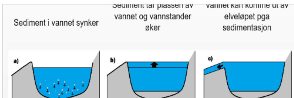
Figur 2-2: Prinsippskisse for erosjon og sedimentasjon (masseavlaging). (Dam, 2018)
