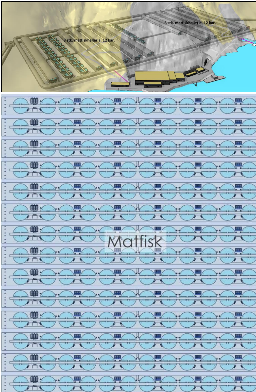
Figur 22. Øverst: Plassering av 14 stk. matfiskhaller i fjell, slik det foreligger på søknadstidspunktet. Nederst: Oversikt over karkonfigurasjonen til matfiskanlegget i 14 adskilte fjellhaller à 12 kar. Fra Artec Aqua AS.
