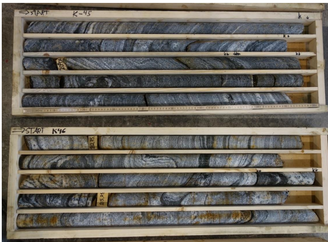
Figur 5: Kjerneborehull BH1. ca. 207-217 m. Gneisen viser tydelig bånding av mørke og lyse bånd, samt foldestrukturer.
