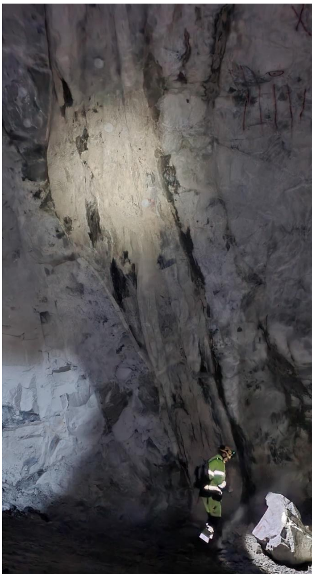
Figur 8: Svakhetszone øverst i spiral, linse 2, nivå 50. Bilde tatt mot øst.
